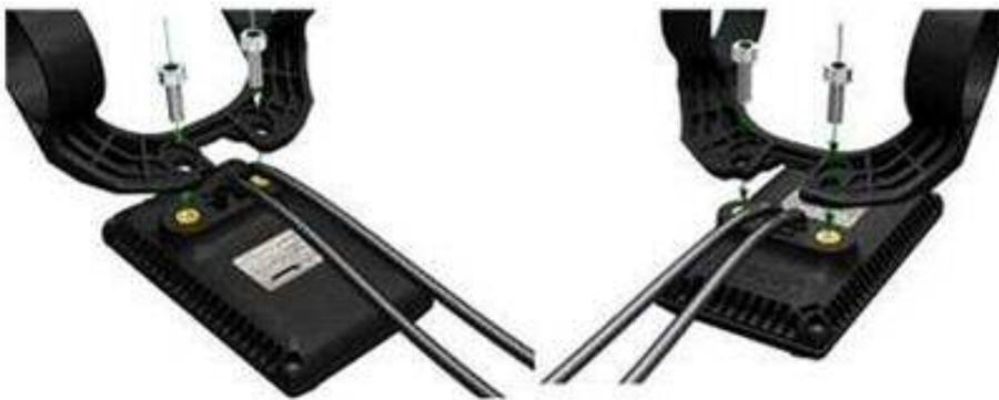
Il y a deux directions pour l'installation des 2 attaches : vers l'avant et vers l'arrière
